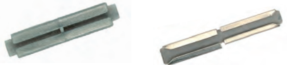
55293 Schienenverbinder mit zwei Schuhbreiten, 6 St. Federstahl-Schienenverbinder mit 2 Schuhbreiten, ermöglichen den Übergang zwischen dem PIKO A-Gleis und dem PIKO Hobby-Gleis, angeboten von 1992 bis 2002, dem Mehano*-Gleis, dem klassischen ROCO* 2,5-mm-Neusilbergleis, dem Fleischmann* Profi- und Modell-Gleis, und anderen Gleisen mit einer Profilhöhe von 2,5 mm, 6 Stück
