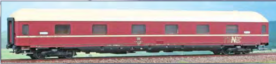
Carrozza letti WLABmh 174 delle DB, in livrea TEN rossa. Sleeping car WLABmh 33 with Minden bogies of DB, TEN livery. Schlafwagen Typ WLABmh 33 mit Minden Drehgestellen der DB, TEN Lackierung.
