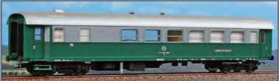
Carrozza Buffet-bar Tipo 1951R delle FS nella livrea verde e grigia. Carrelli Tipo FS 24 . Italian Railways Type 1951R Buffet-bar car in gray and green livery. Type FS 24 bogies. 1. Klasse Büffet-Barwagen Typ 1951 R der FS in grau/grüner Lackierung, wie für einige Jahre im "Alpen-Express" Rom-München " verwendet. Typ FS 24 Drehgestelle.
