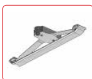
L938993 Mittelkontakt-Schleifer für Versionen des Turmtriebwagens.
