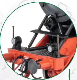
Neu konstruierte Laternen. Newly designed lanterns.
